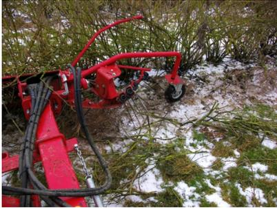
Der Schwader transportiert das Schnittgut in die Reihenmitte. In diesem Fall ist das Gerät hinten angebaut , was ungünstig ist. Im Frontanbau verwendet kann hinten der Mulcher mitlaufen.
