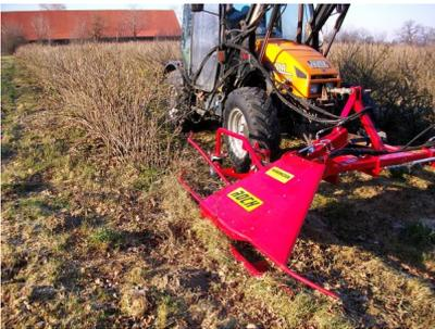
Bei der Frontmontage kann man das Gerät am besten an die Pflanzreihe lenken.
