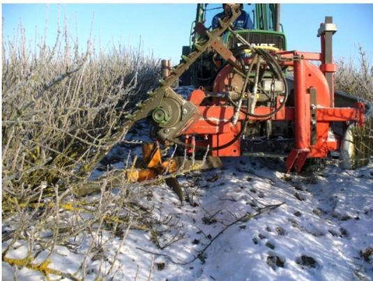
Dieses Gerät arbeitet mit einem vielfältig verstellbaren Messerbalken. Das Schnittgut wird mit einem Gummipaddel in die Mitte befördert.
