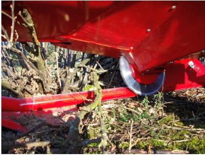
Nah am Strauch läuft das hydraulisch angetriebene Sägeblatt.
